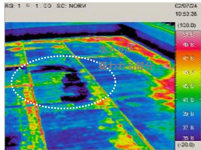
屋上防水シートに浸入した水の検出。可視画像と比較することで、どの部位に異常があるかの判断が分かり易く簡単に行えます。
