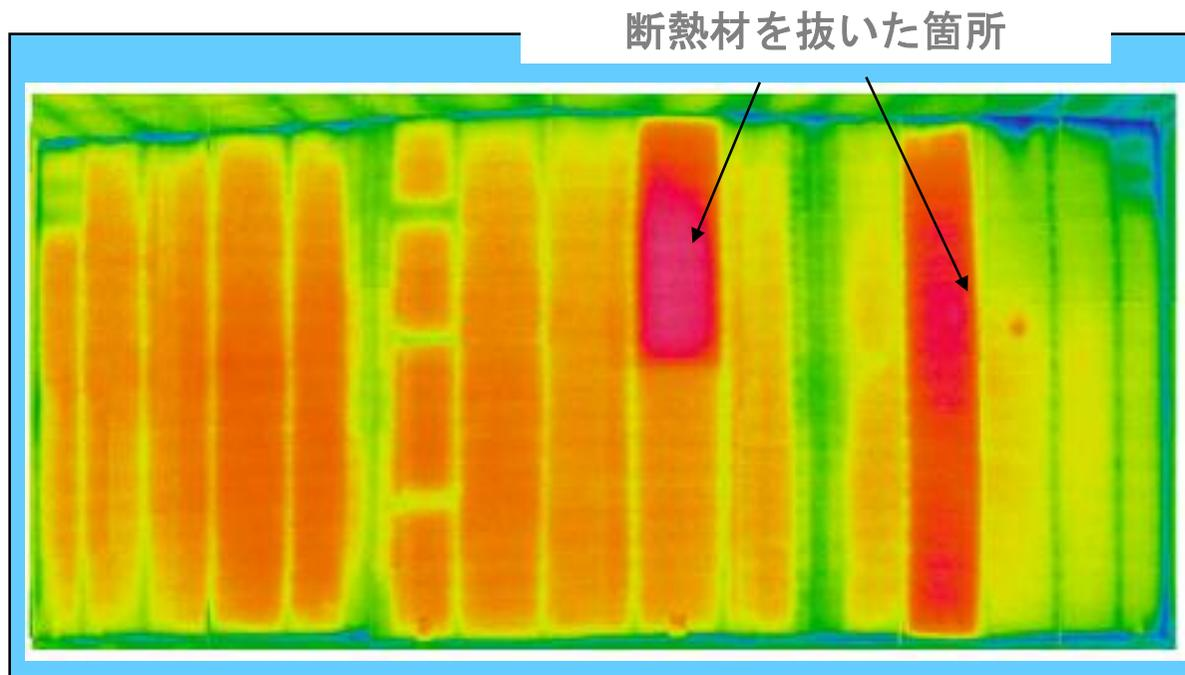
意図的に断熱材を抜いた実験壁
